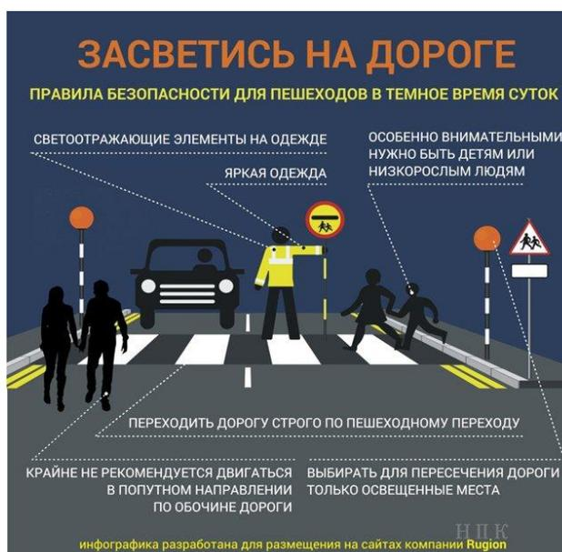
Световозвращатель на одежде - на сегодняшний день реальный способ уберечь ребенка от травмы на неосвещенной дороге. Принцип действия его основан на том, что свет, попадая на ребристую поверхность из специального пластика, концентрируется и отражается в виде узкого пучка. Когда фары автомобиля «выхватывают» пусть даже маленький световозвращатель, водитель издалека видит яркую световую точку. Поэтому шансы, что пешеход или велосипедист будут замечены, увеличиваются во много раз.
